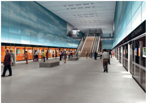
Lauttasaaren aseman sijainti syvällä kalliossa on hyödynnetty korkeana ja avarana tilana. Pääsisäänkäynnin lippuhalli sijaitsee aseman itäpäässä laiturin yläpuolisella välitasolla, mistä on yhteydet edelleen ostoskeskukseen ja mahdolliseen kalliopysäköintiin.
